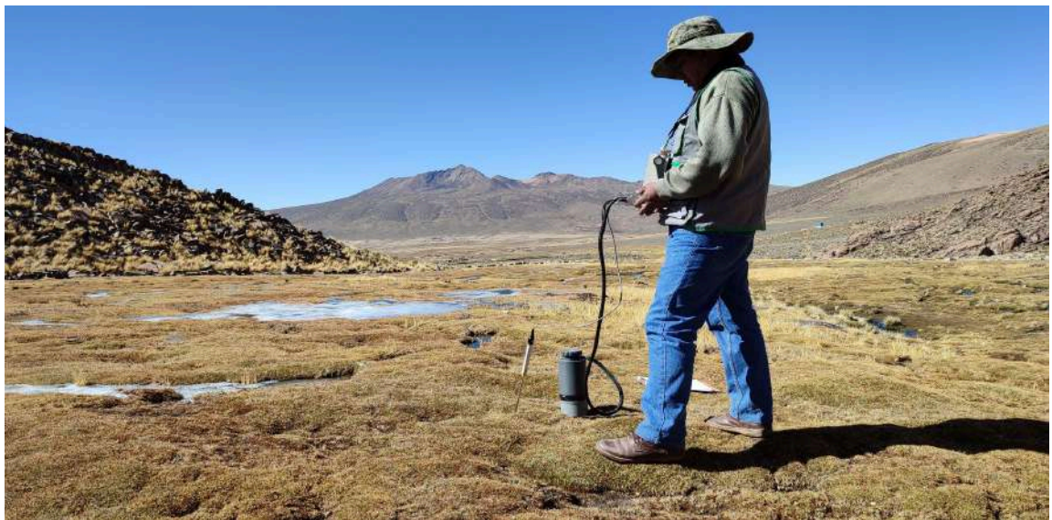
Figura 19: Programación del equipo EGM-4 antes de la medición
