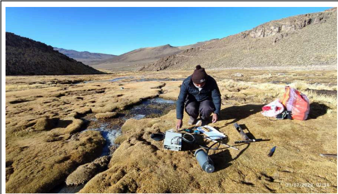
Figura 10: Equipos utilizados en medición de flujo de CO 2
