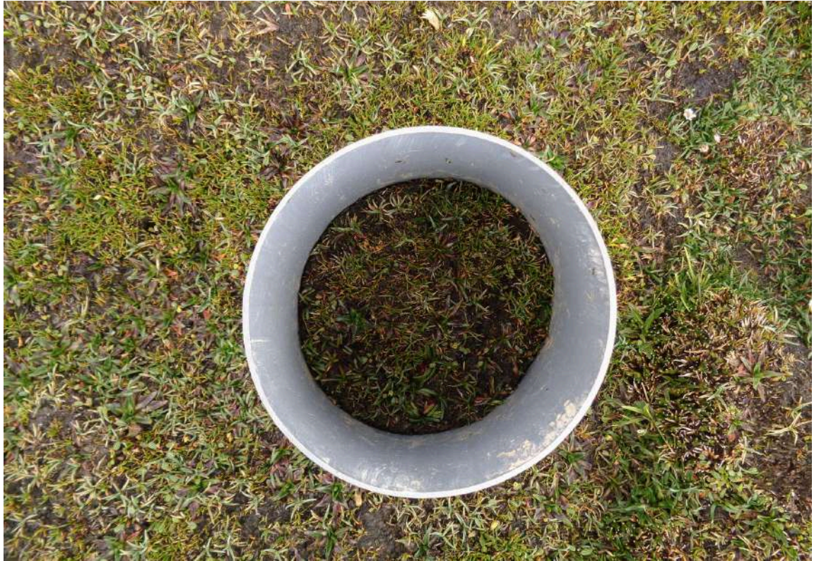
Figura 31: Tubos de PVC utilizados para medición de flujo de CO 2
