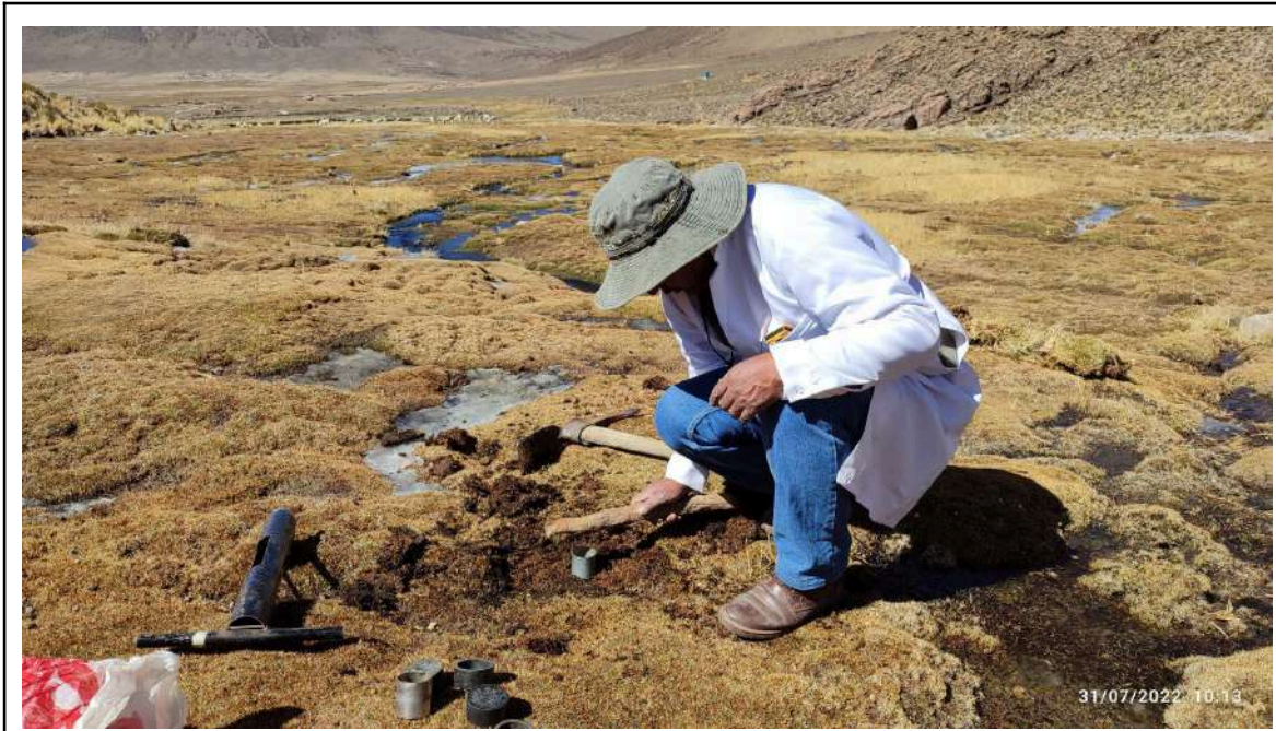
Figura 24: Muestreadores inseridos al suelo
