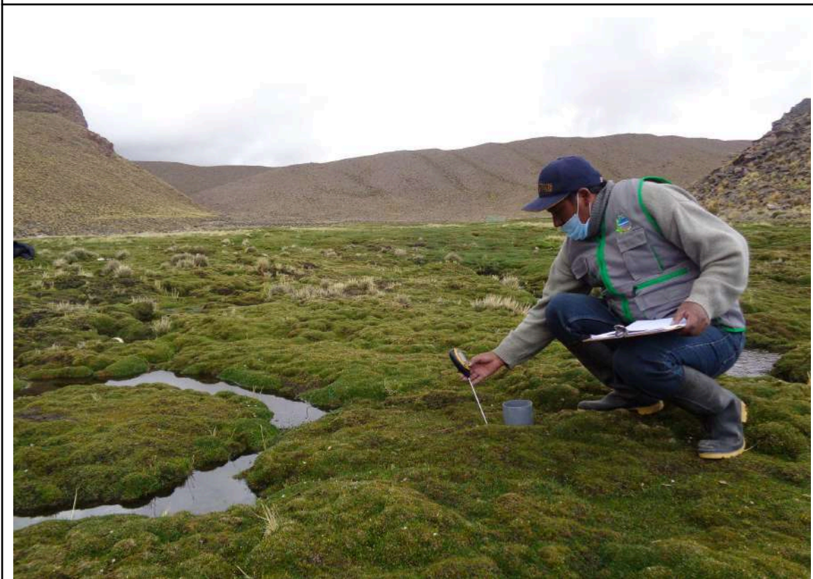
Figura 30: Medición de pH del suelo
