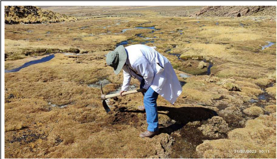
Figura 22: Limpiando terreno para muestreo en cilindros para densidad aparente
