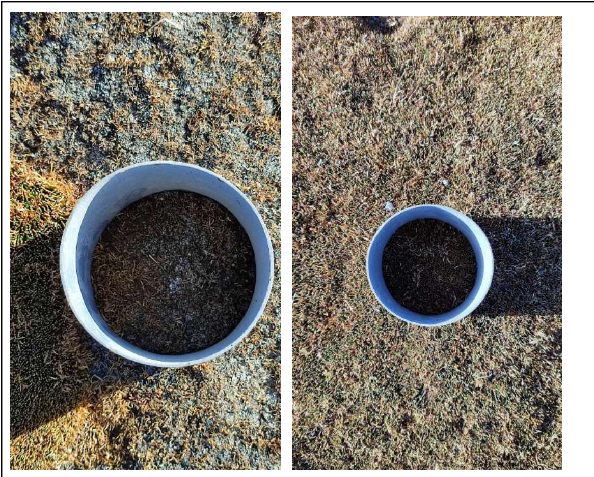
Figura 16: Cámaras utilizadas para medición de flujo de CO 2
