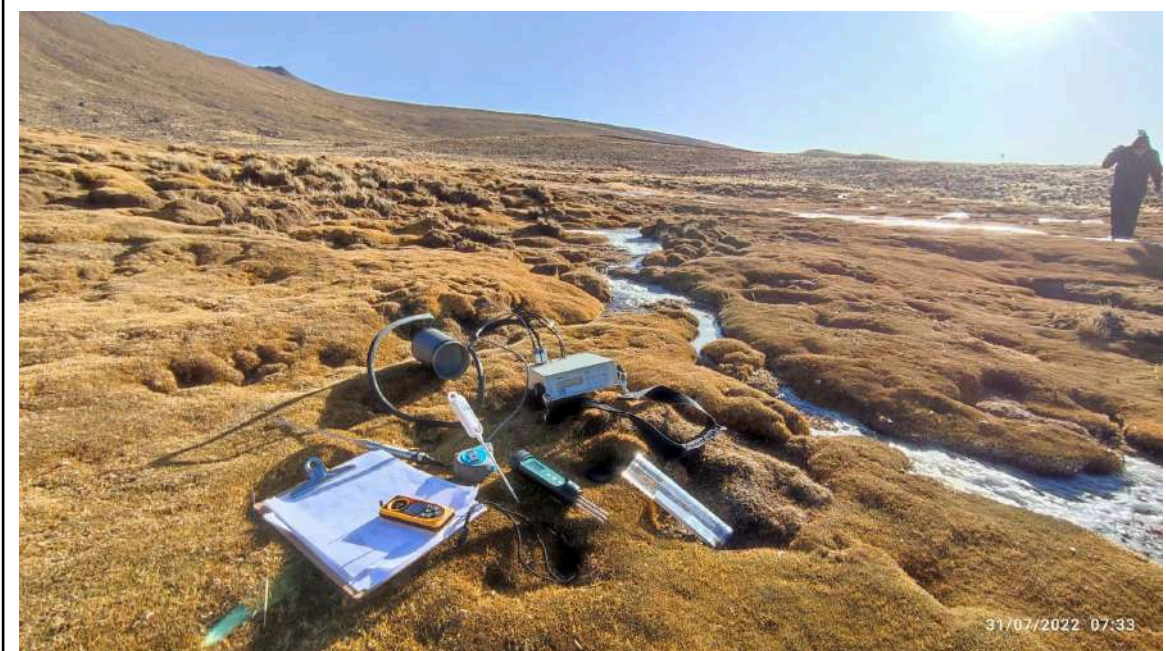
Figura 09: Equipos utilizados para medición de CO 2 e variables ambientales
