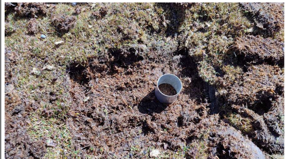
Figura 23: Cilindros me muestreo para densidad aparente
