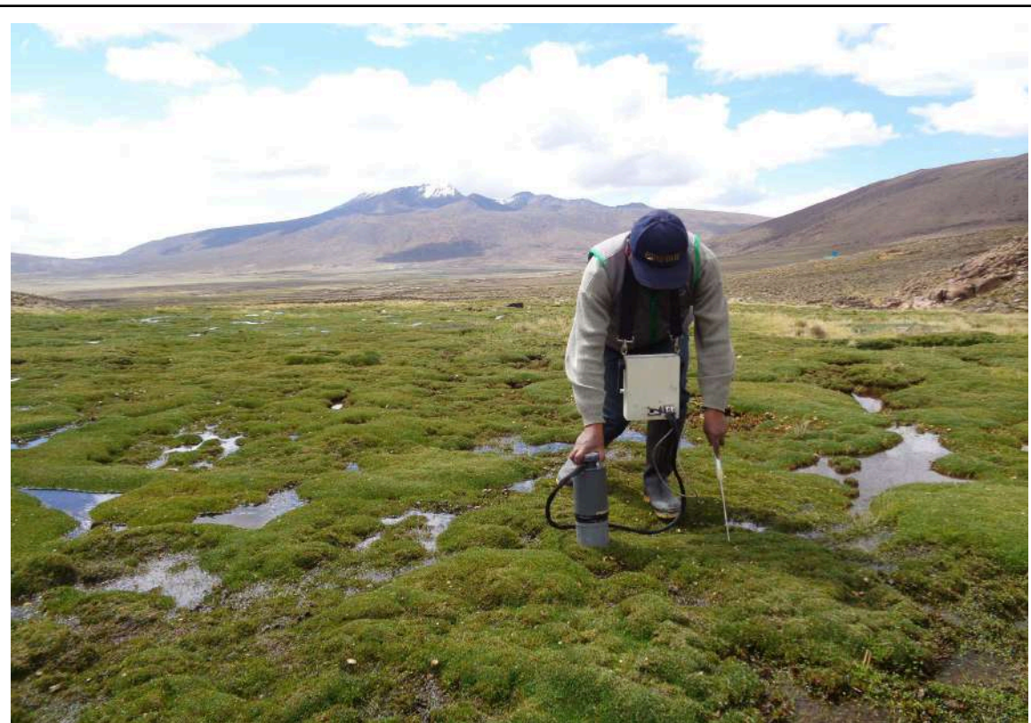
Figura 34: Inserindo equipo EGM-4 para medición de concentración de CO 2
