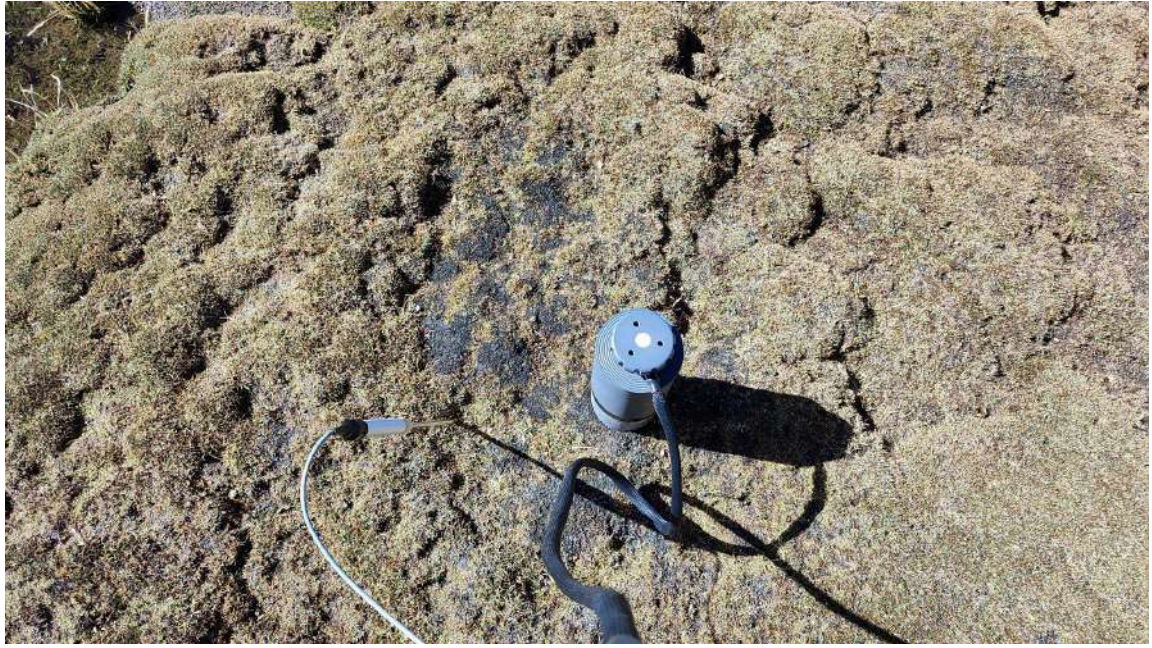
Figura 18: Medición de concentración de CO 2 del suelo
