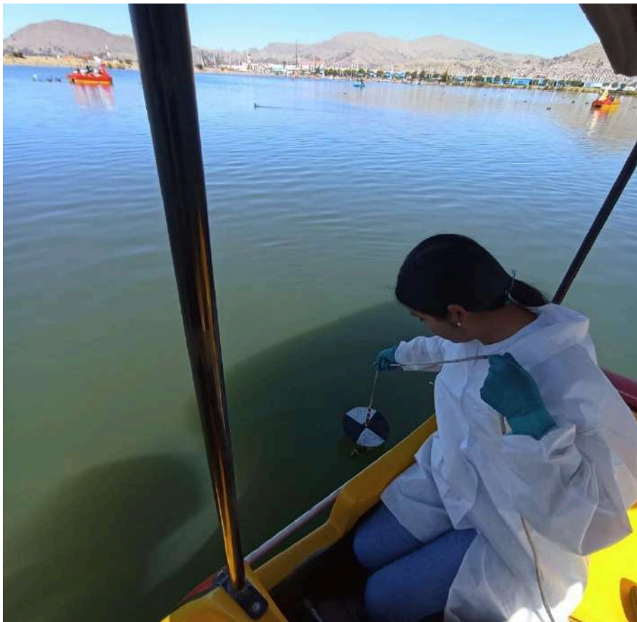
Figura 15: Uso de disco secchi para medir transparencia.
