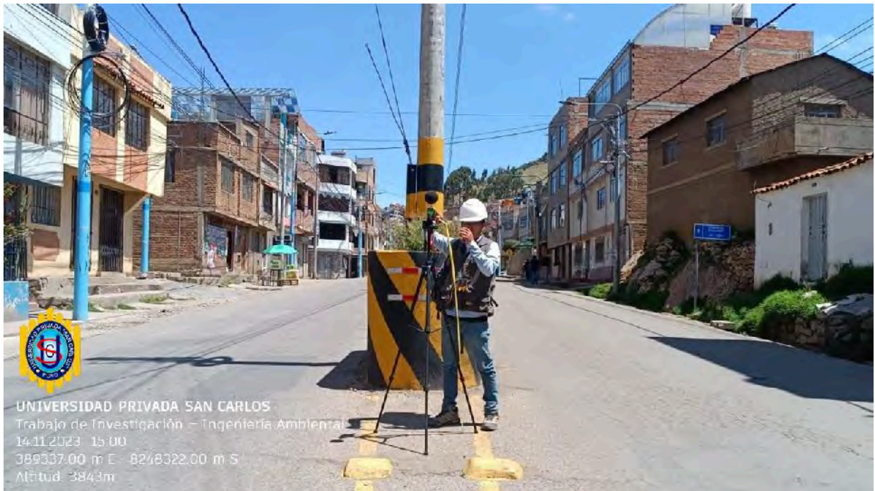
Fotografía 14. Instalacion del sonómetro a 1,5 metro según Protocolo Nacional de Monitoreo de Ruido Ambiental en la estación de monitoreo de nivel de presión sonora PM-17; Av. Circunvalación intersección Jr. Bolognesi
