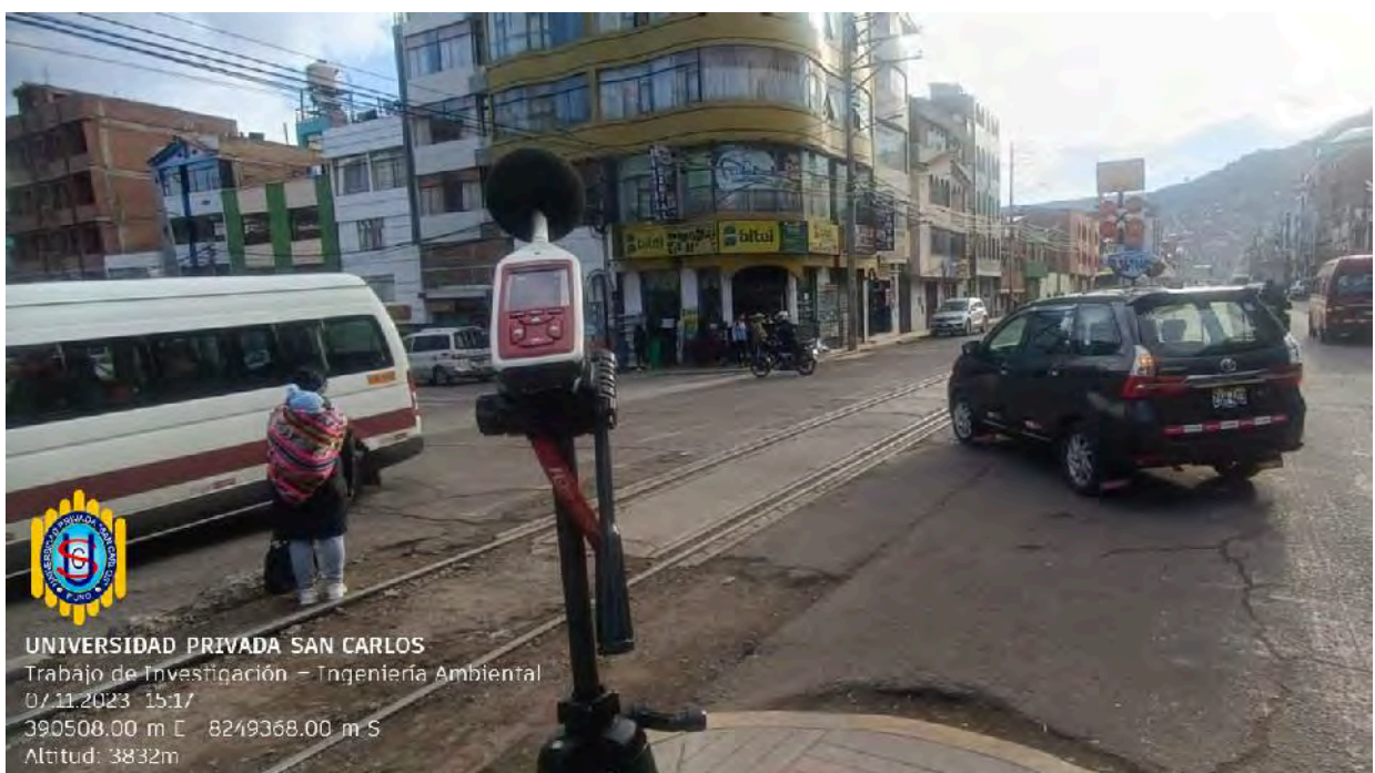
Fotografía 25. Estación de monitoreo de nivel de presión sonora PM-14; Av. Floral intersección Jr. Simon Bolivar.
