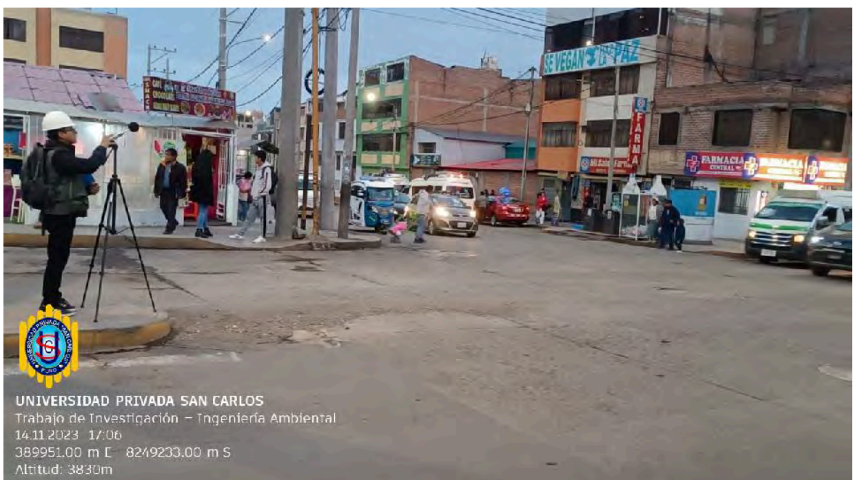
Fotografía 04. Estación de monitoreo de nivel de presión sonora PM-13; Av. La Torre intersección Av. Floral.
