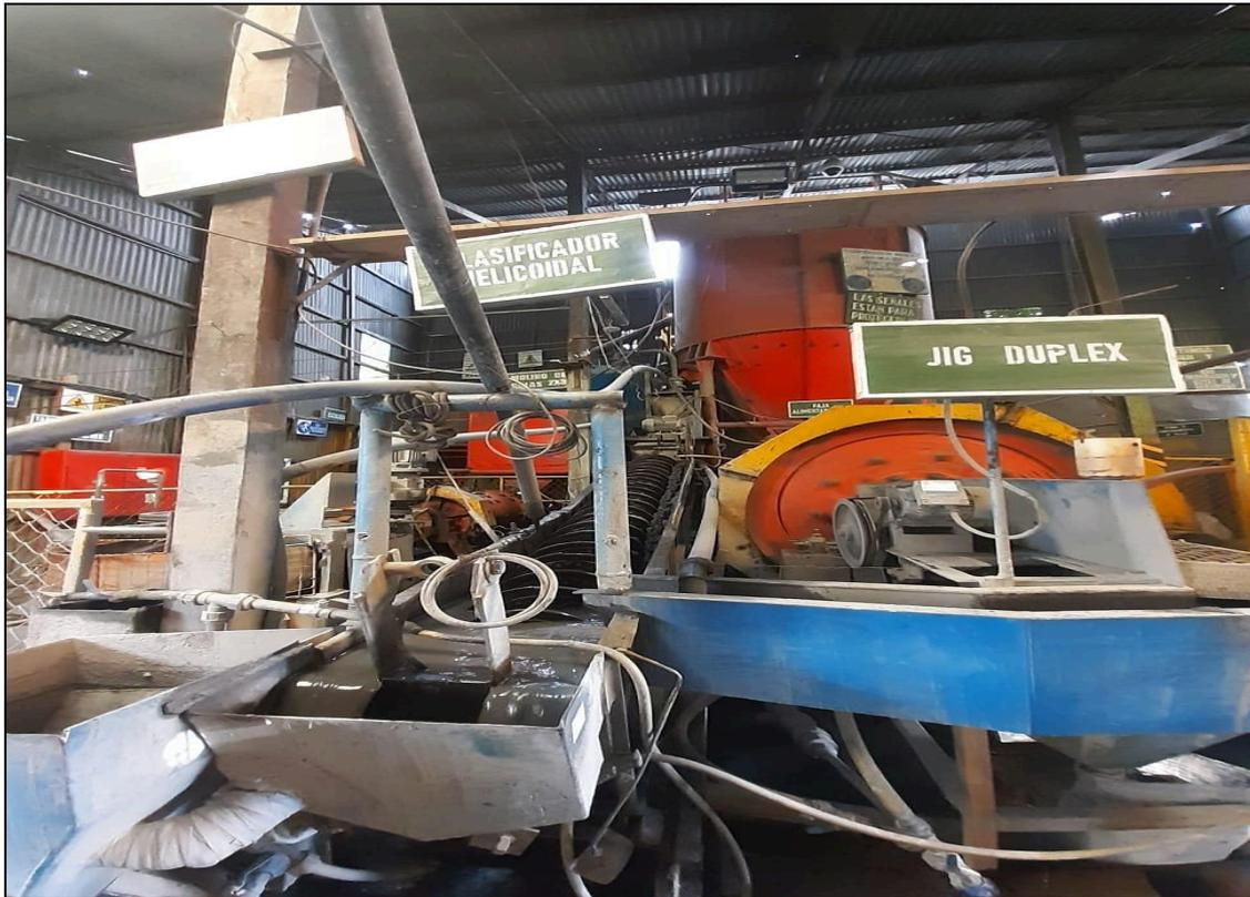
Figura 3: Se observa Molino 4x4 la planta de beneficio de la empresa minera Corporación Minera Ananea S. A.
