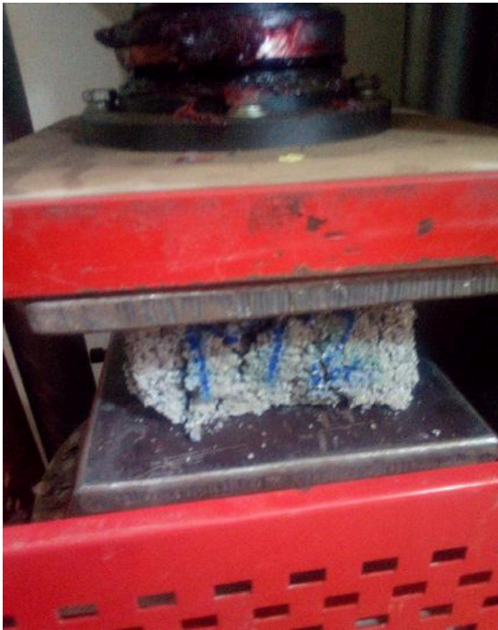
Rotura de la muestra ( M_2 ).
