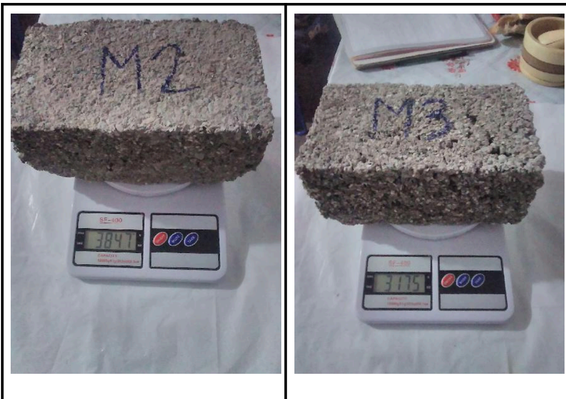
Pesaje de las muestras (M 2 M 3 )
