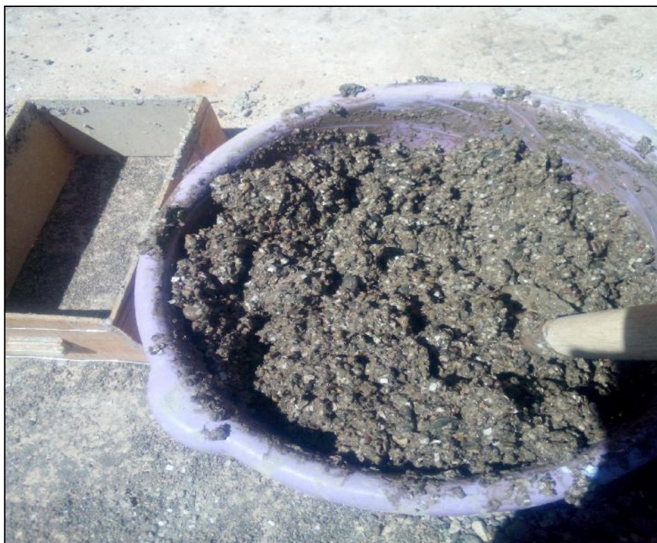
Figura 09: Mezcla de plástico PET, papel reciclado, cemento, arena y agua.
