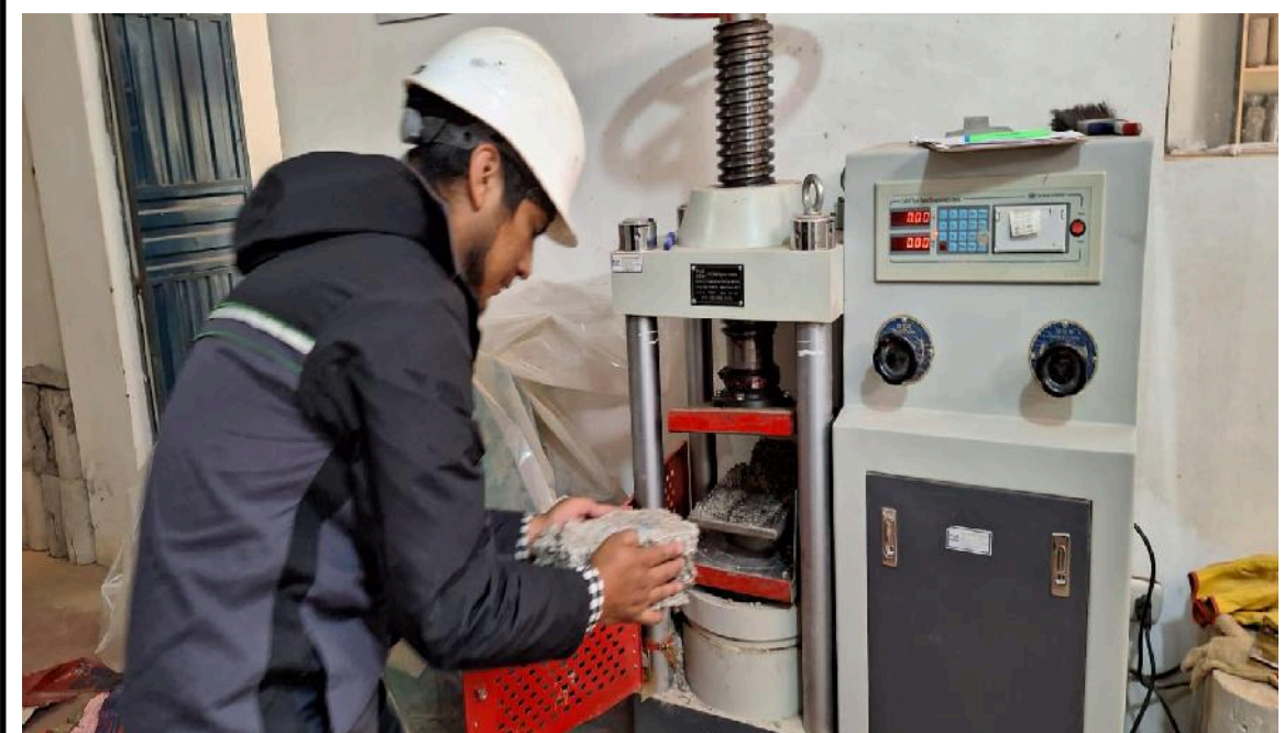
Ensayo de ruptura de ladrillo para la prueba de compresión.
