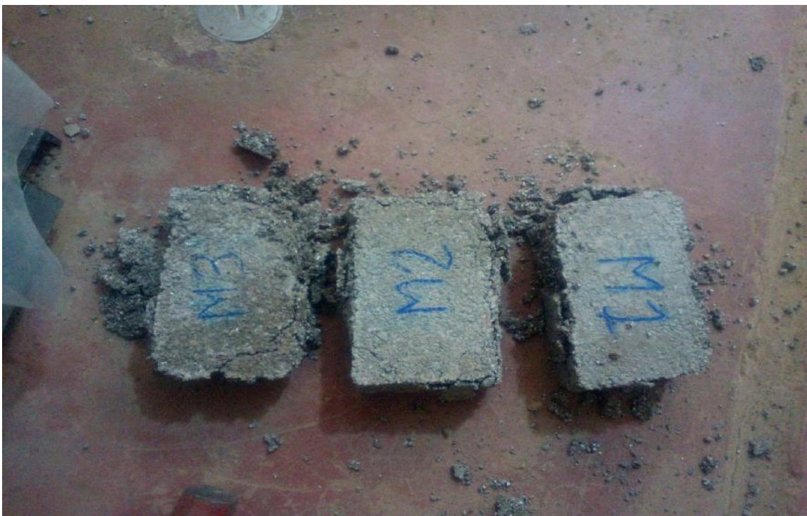
Ruptura de las tres muestras ( M_1 M_2 M_3 ) de ladrillos ecológicos.
