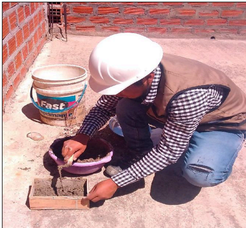
Figura 10: Vertimiento de mezcla al molde de ecoladrillo.
