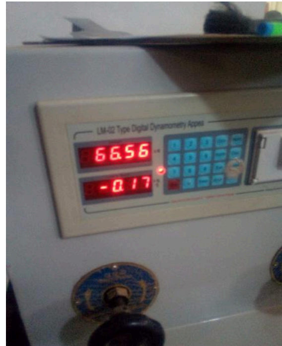
Resultado de compresión de la muestra ( M_2 ).
