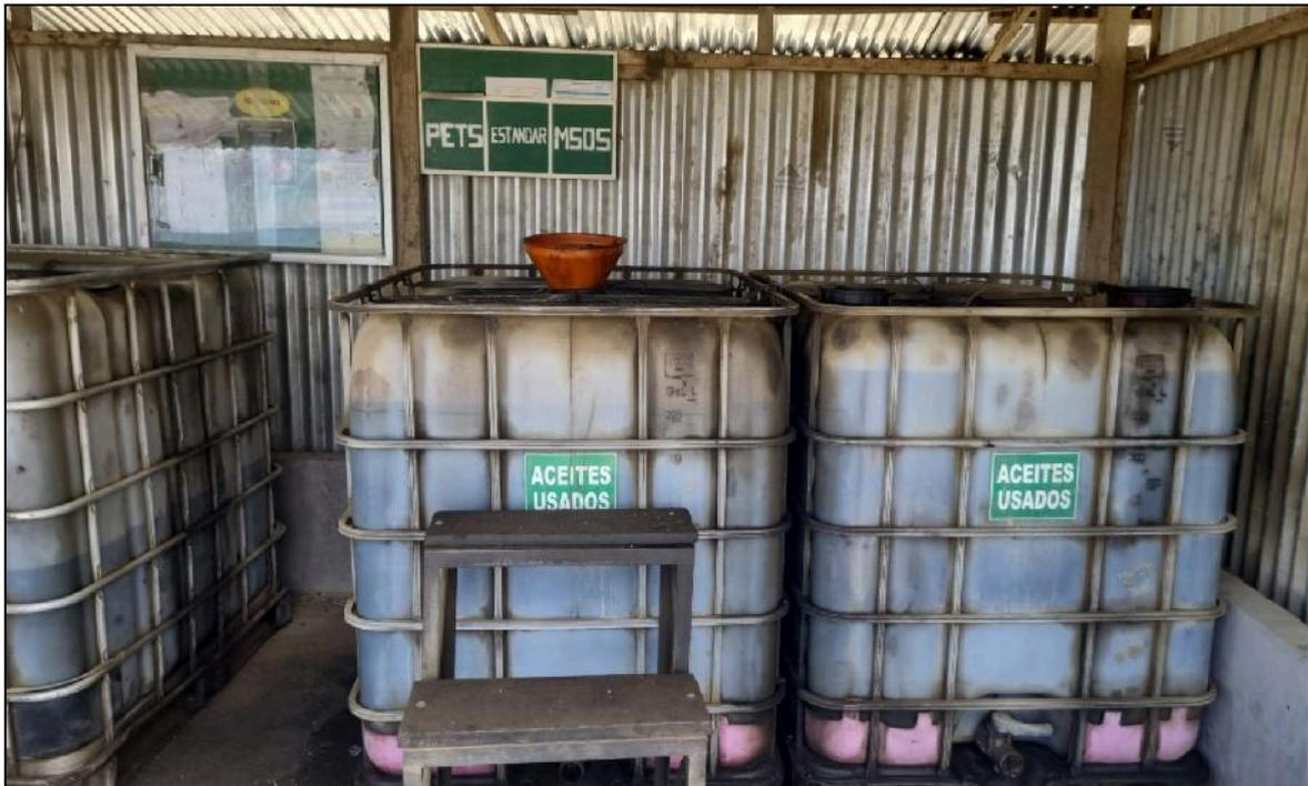
**Figura 12:** Contenedor IBC de 1000 litros para aceites usados.
