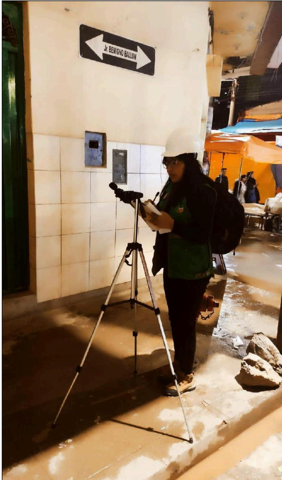
**Figura 18:** Calibración del sonómetro para el monitoreo en el punto 2
