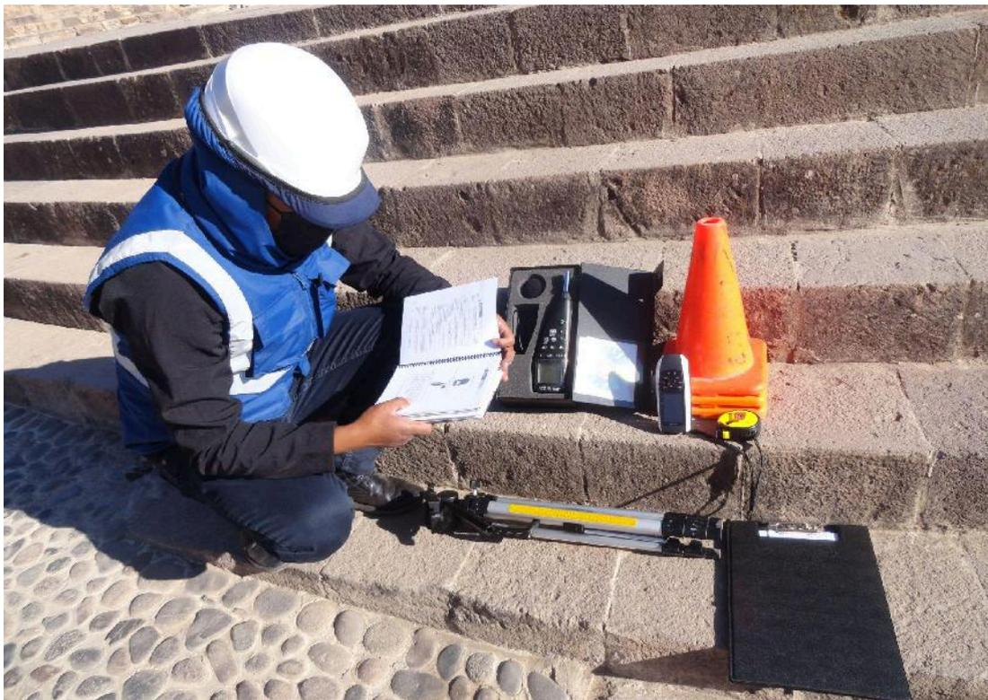
**ANEXO 15: UBICACIÓN DEL TRÍPODE DE SUJECCIÓN A 1.5 M. SOBRE EL PISO**
