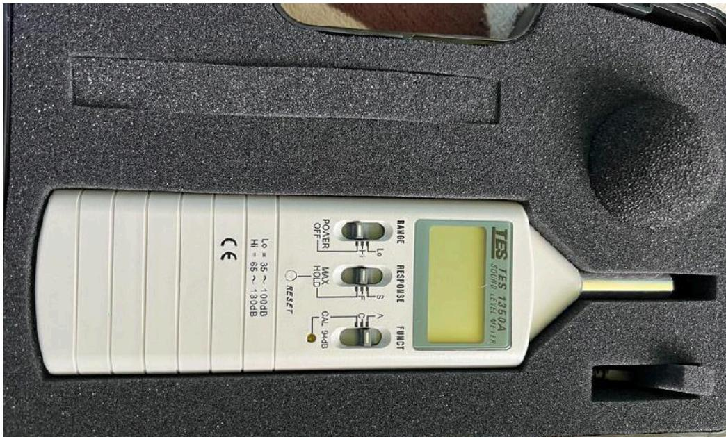
Figura 09: Sonómetro Marca TES1350A
