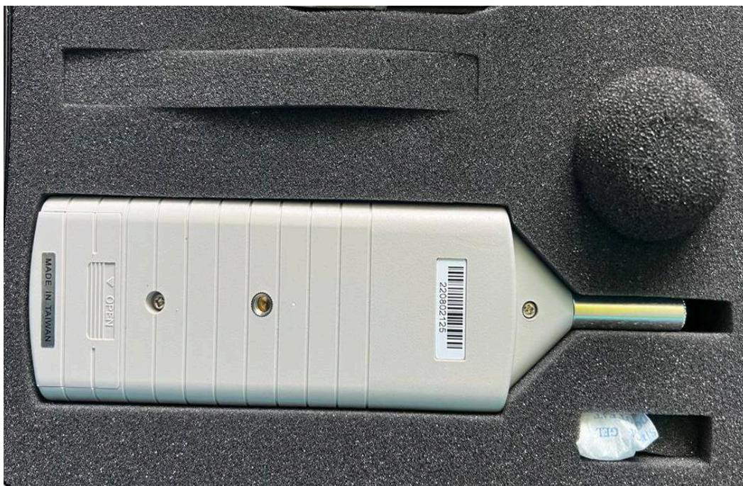
Figura 10: Sonómetro Marca TES1350A Serie 220802125
