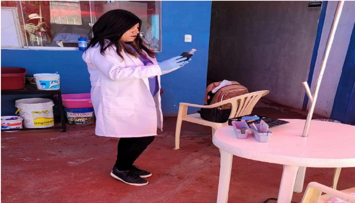
**Figura 21:** Realizando muestra de cloro residual de la vivienda intermedia en el distrito de Paucarcolla.
