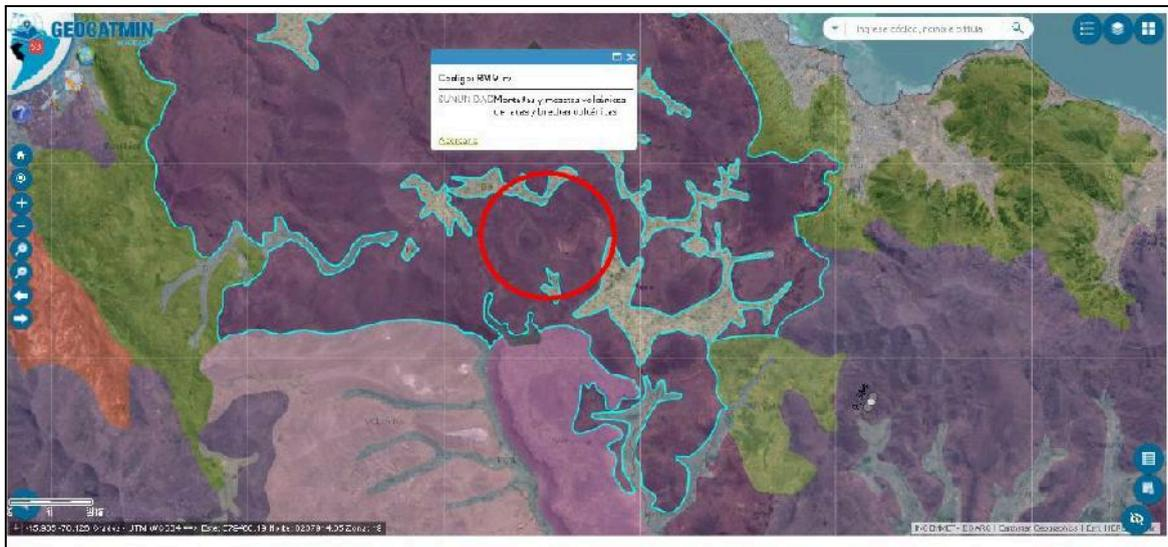
**Figura 07:** Zonas donde se puedan generar asentamientos o deslizamientos que desestabilicen la integridad de la infraestructura de residuos sólidos.
