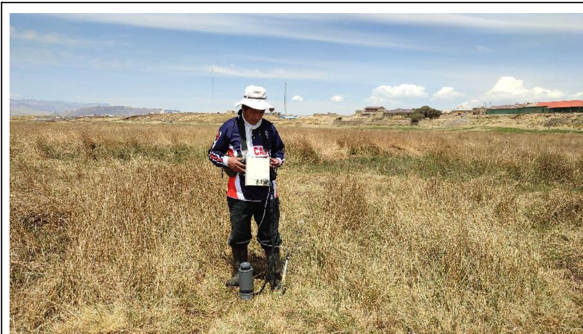
Figura 10: Realizando configuración para reiniciar la medición en nueva cámara de flujo de CO 2
