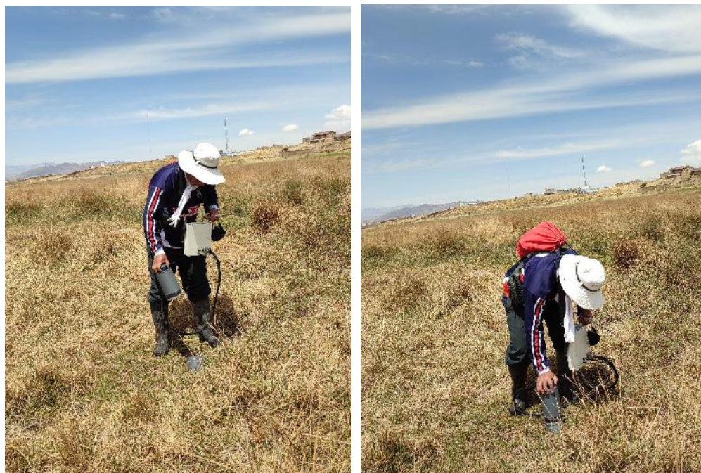
Figura 12: Colocar la cámara de respiración en los tubos de PVC
