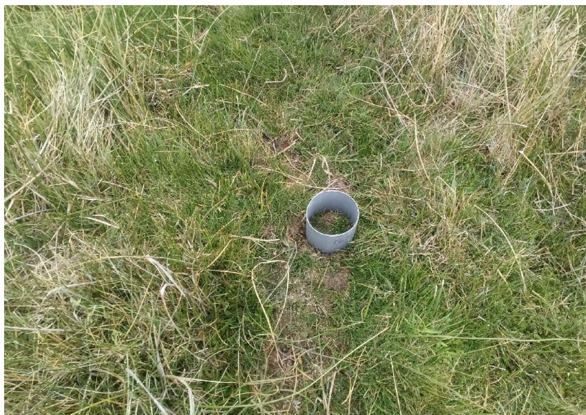
Figura 16: Tubo de PVC para medición de flujo de CO 2 del suelo
