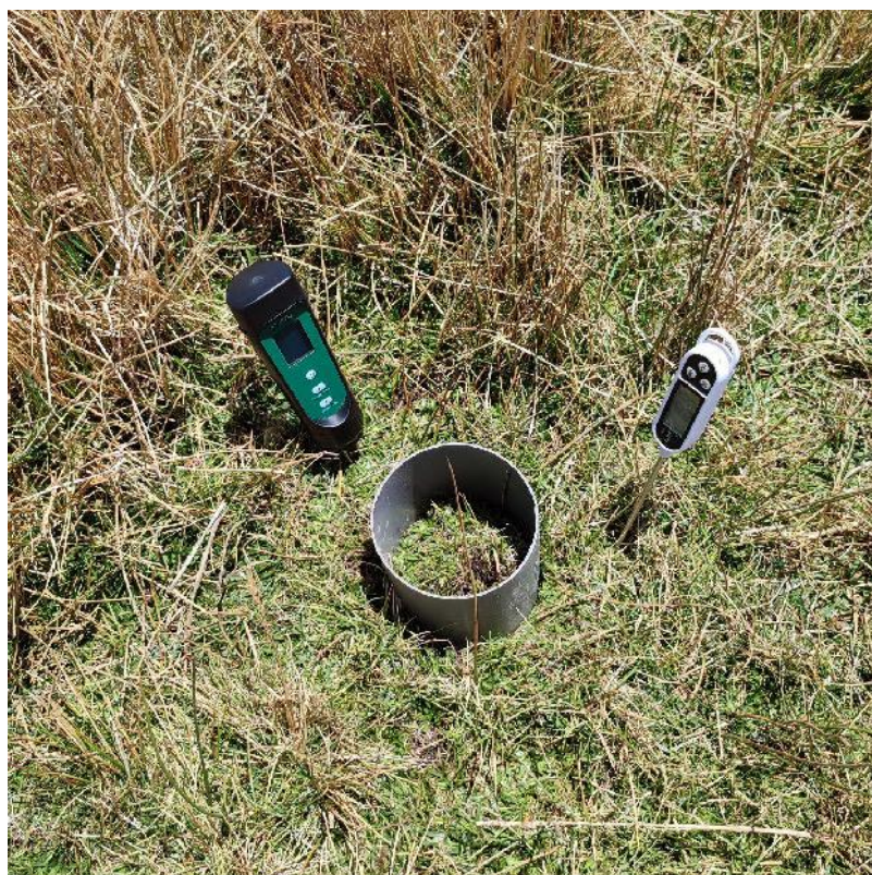
Figura 07: Cámara de flujo, termómetro y medidor de humedad del suelo
