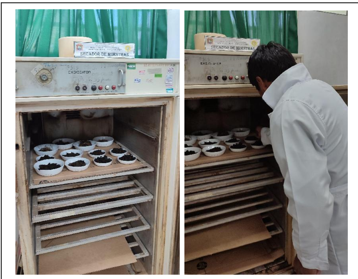
Figura 29: Muestras de suelo y raíces para secado
