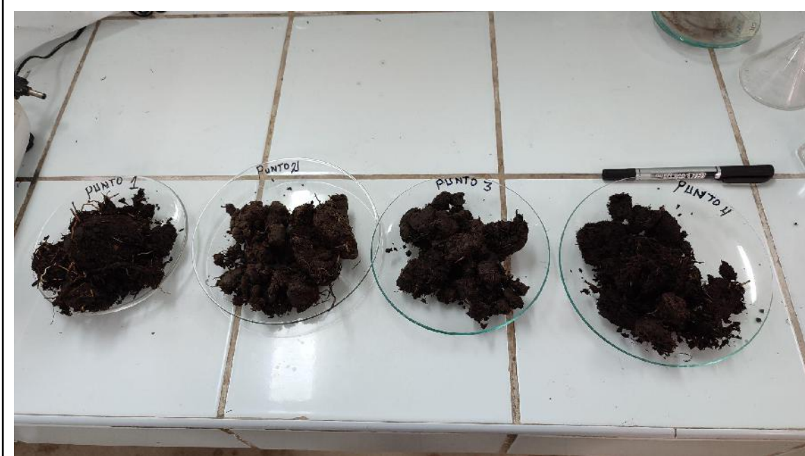
Figura 24: Muestras de suelo para determinar porcentaje de humedad
