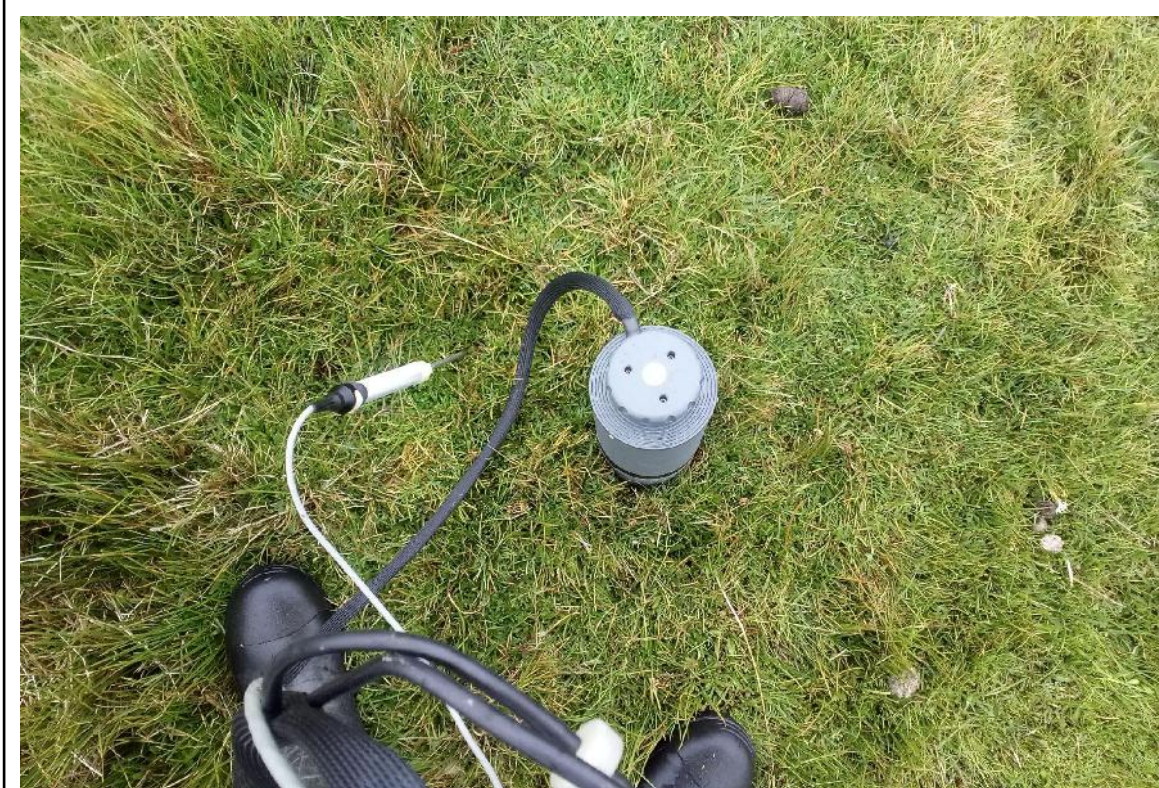
Figura 19: Cámara de respiración (SRC-1, PP Systems, USA) y STP-1 y Sonda de Temperatura del Suelo
