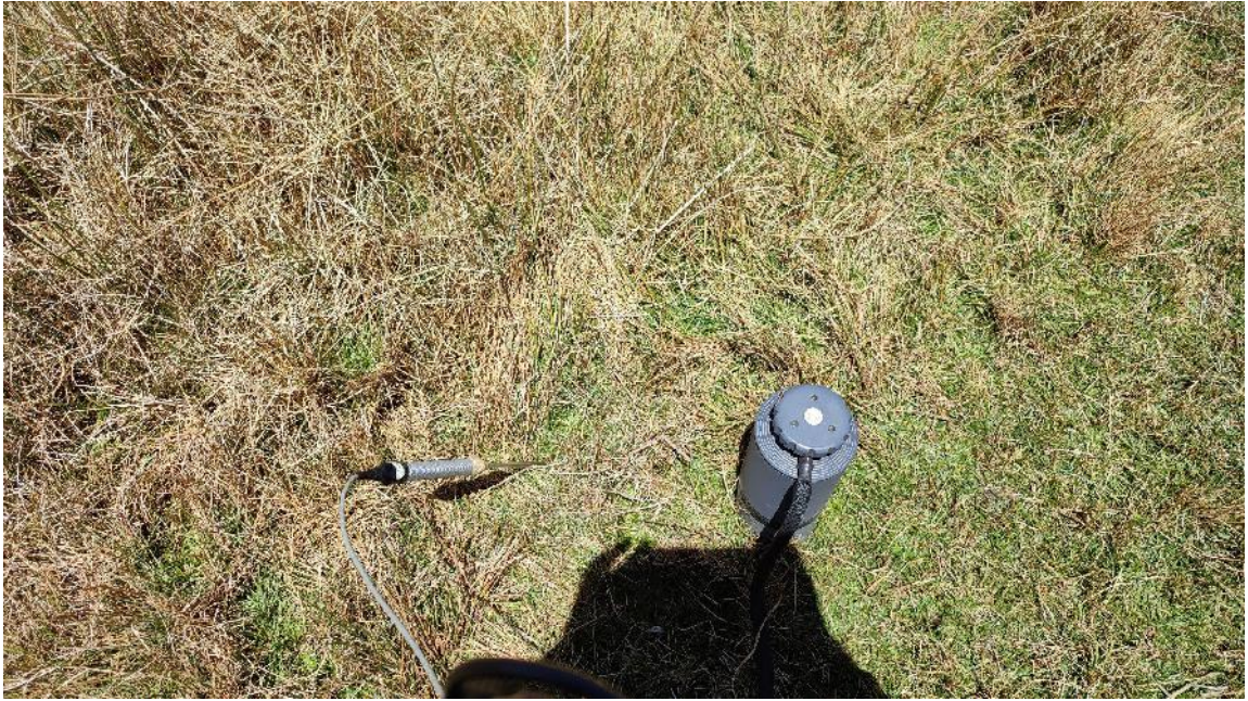
Figura 08: Cámara de respiración (SRC-1, PP Systems, USA) y STP-1 y Sonda de Temperatura del Suelo
