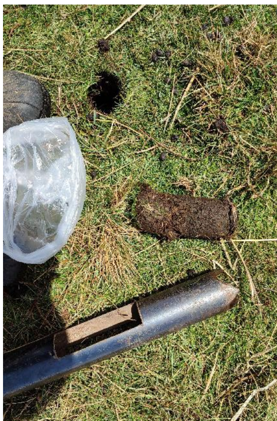
Figura 13: Muestreo de suelos para análisis en laboratorio
