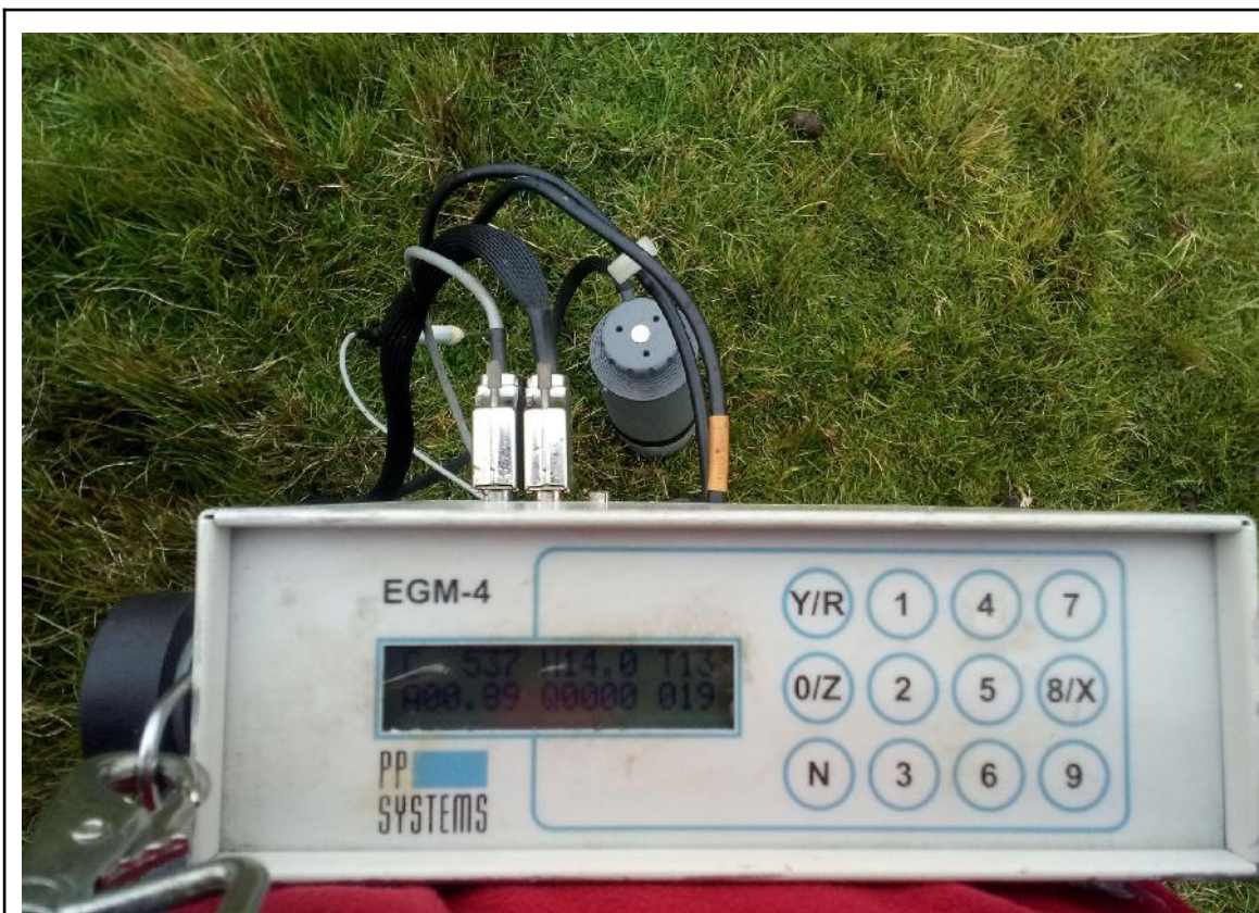
Figura 18: Analizador de gases infrarrojo (IRGA) (EGM-4, PP Systems, USA)
