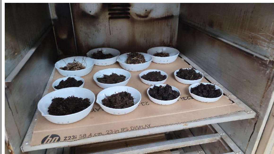
Figura 30: Muestras de suelo en estufa para determinar porcentaje de humedad
