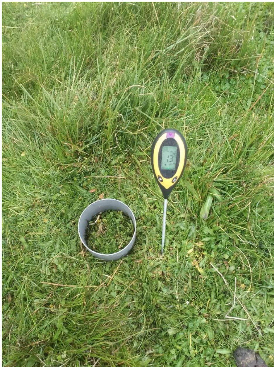
Figura 22: Medición de pH del suelo
