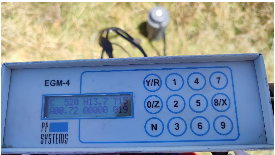
Figura 09: Analizador de gases infrarrojo (IRGA) (EGM-4, PP Systems, USA)
