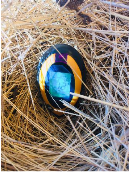
Fotografía 05: Medición de la temperatura de la pila.
