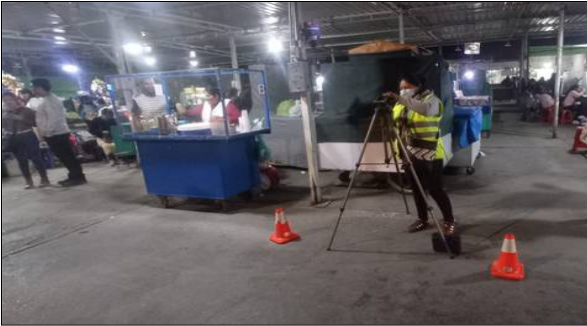
Figura 43: Instalación de Sonómetro horario nocturno
