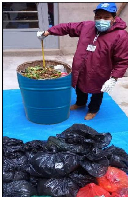
**Figura 06:** Utilización del cilindro para el cálculo de las densidades de los residuos sólidos.
