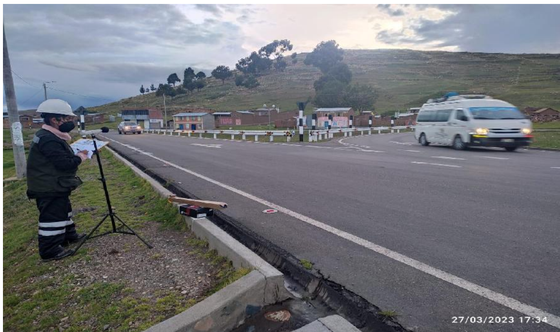
Figura 26: Medición sonora en el PR-06 del óvalo de Asillo
