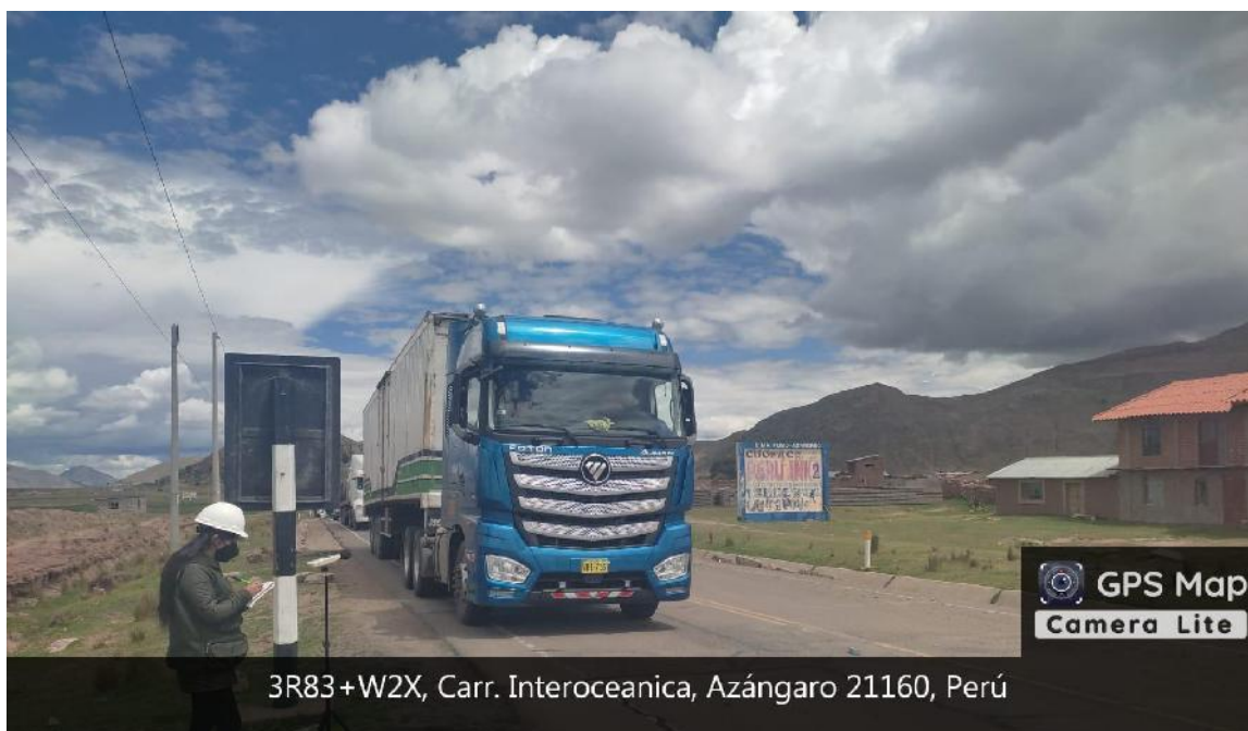
Figura 15: Medición sonora en el PR-16 del óvalo de Azángaro
