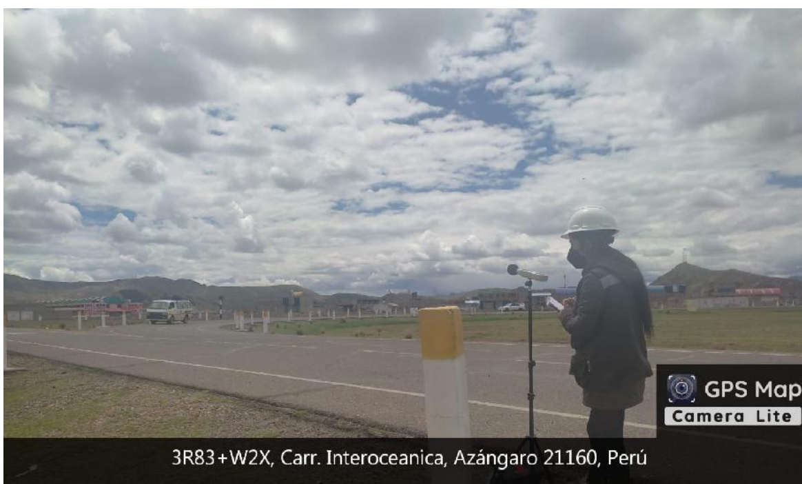
Figura 17: Monitoreo de ruido en PR-14 del óvalo de Azángaro
