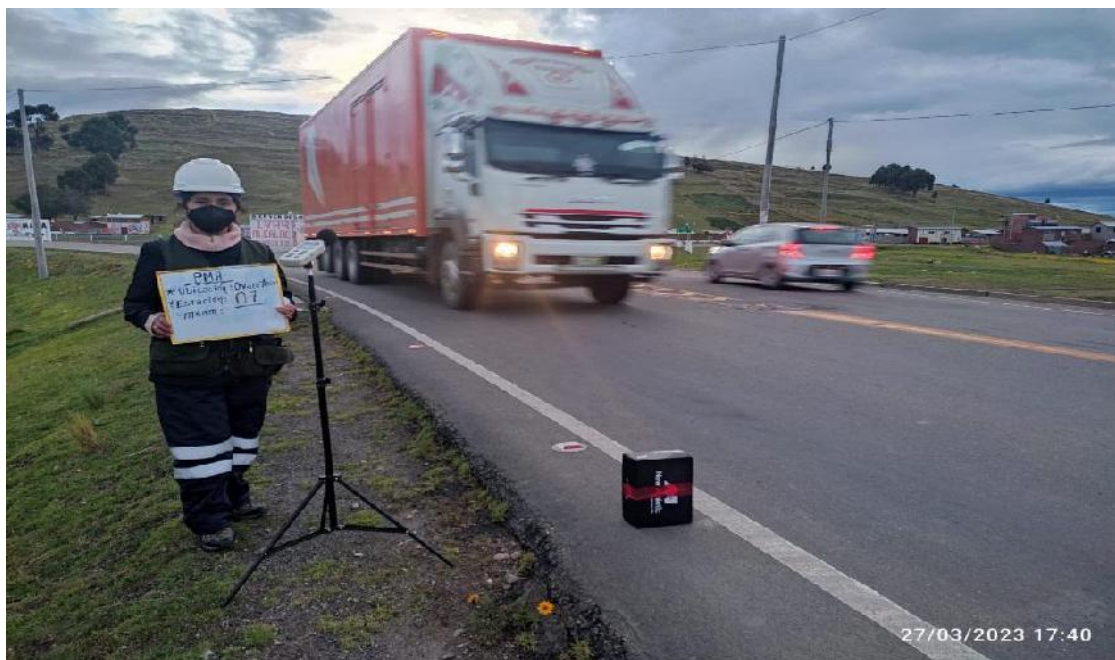
Figura 24: Medición sonora en el PR-07 en el óvalo de Asillo
