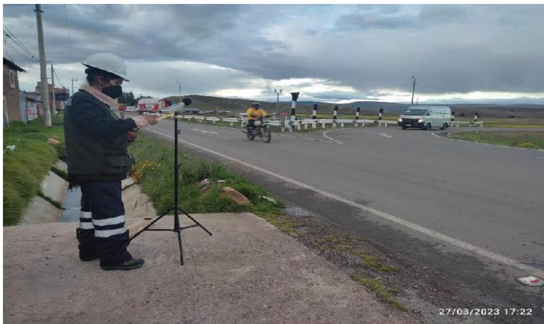
Figura 28: Medición sonora en el PR-03 del óvalo de Asillo
