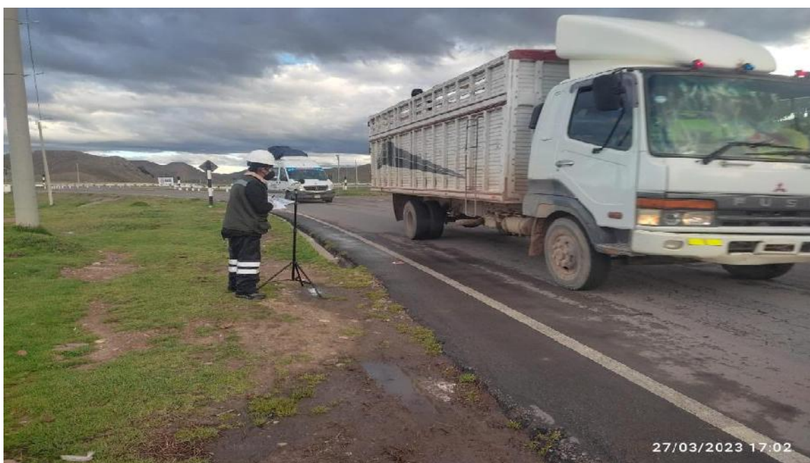
Figura 31: Medición sonora en el PR-02, ubicado en el óvalo de Asillo
