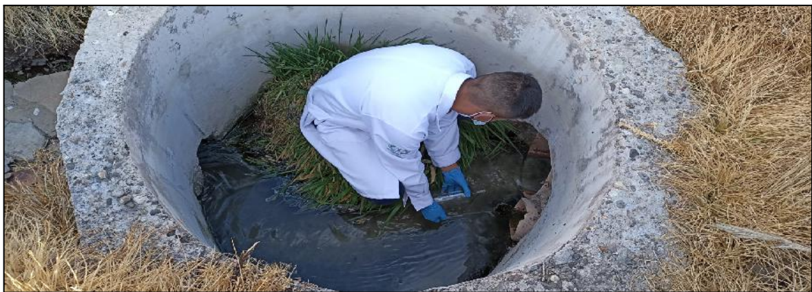
Figura 02: Toma de muestras del efluente de la PTAR del distrito de Chucuito.
