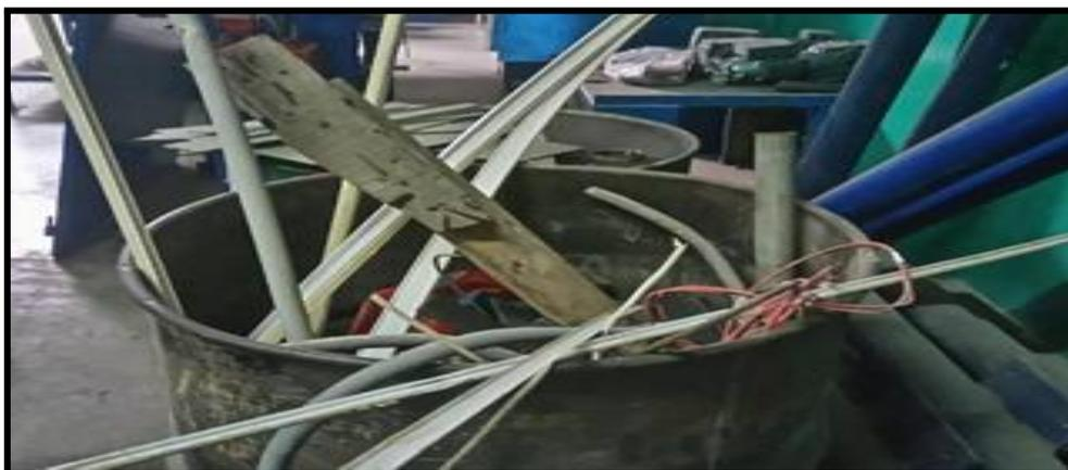
**Figura 06 :** Residuos de fierros del área de soldadura(Los residuos que son de mayor dimensión como fierros, maderas, plásticos son dispuestos sin una adecuada separación en contenedores de mayor tamaño que no presentan rotulación)
