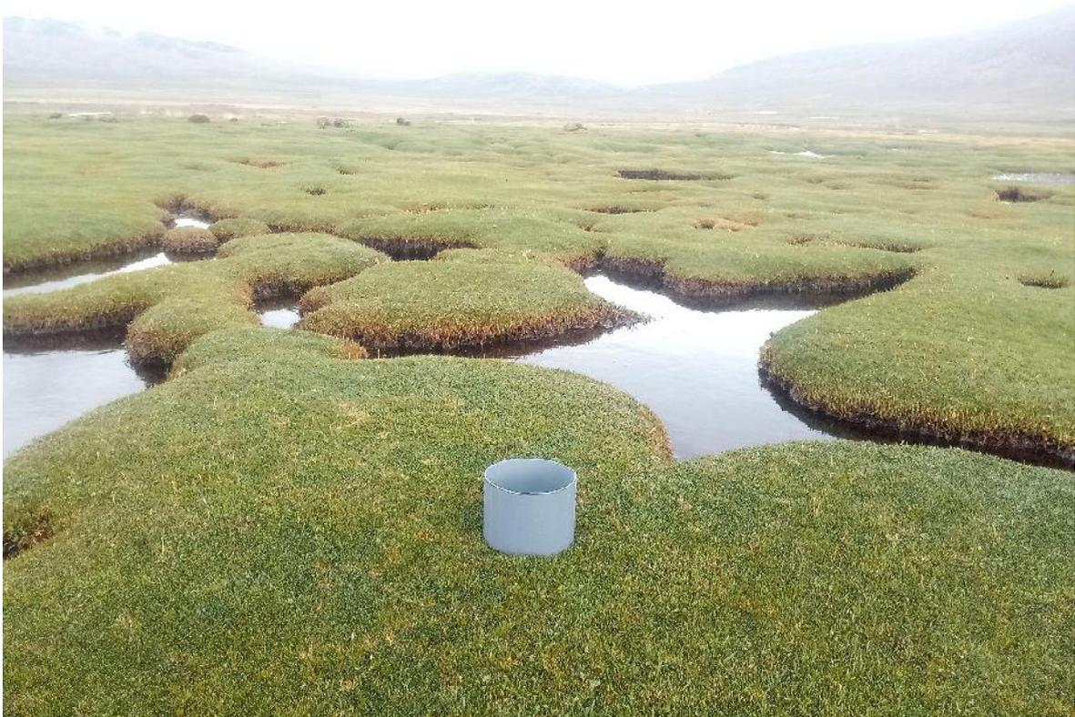
**Figura 08:** Cámara de flujo de gases utilizados para medir la concentración de  $\text{CO}_2$
