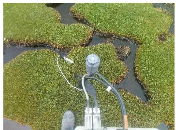
**Figura 25.** Medición de la concentración de CO<sub>2</sub> durante 2 min
