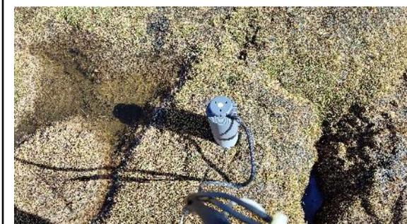
**Figura 24.** Medición de la concentración de CO<sub>2</sub> durante 2 min
