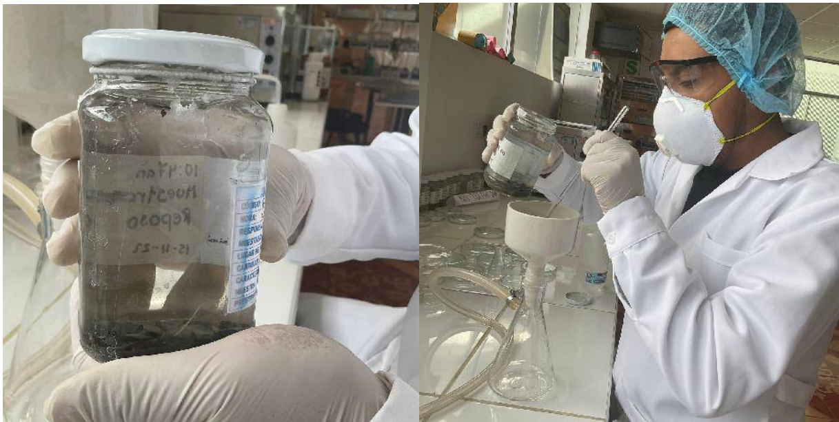
Figura 33: Separación de MP por bomba al vacío y papel filtro de las muestras en reposo
