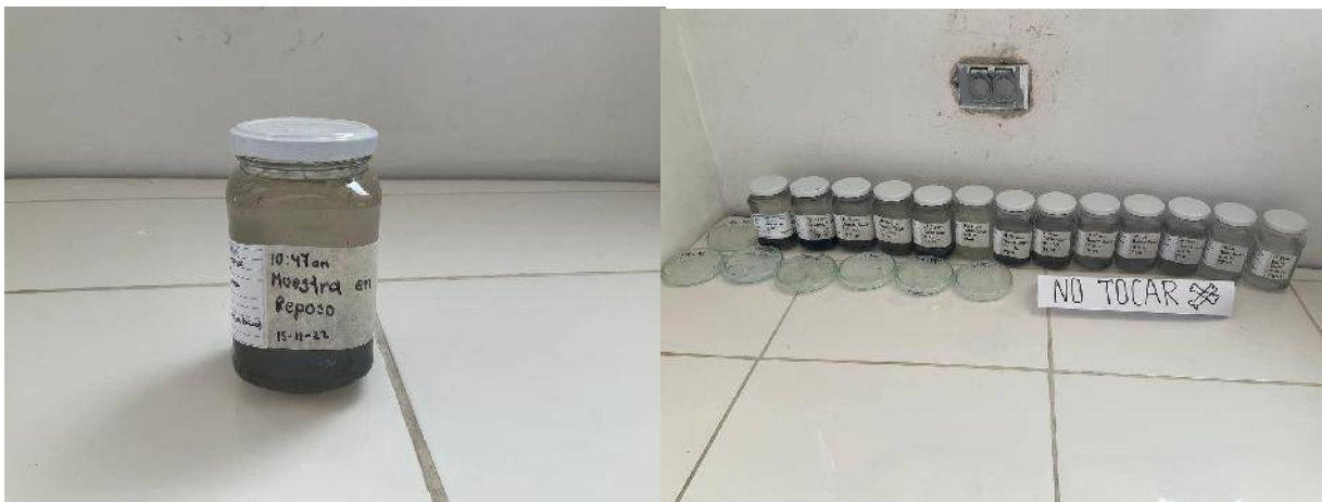
Figura 32: Muestras dejadas en reposo con la solución de NaCl para la separación por densidad
