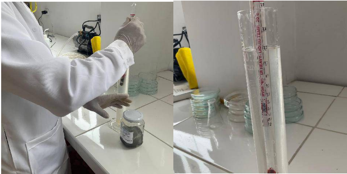
Figura 31: Medición de la densidad de la solución de NaCl
