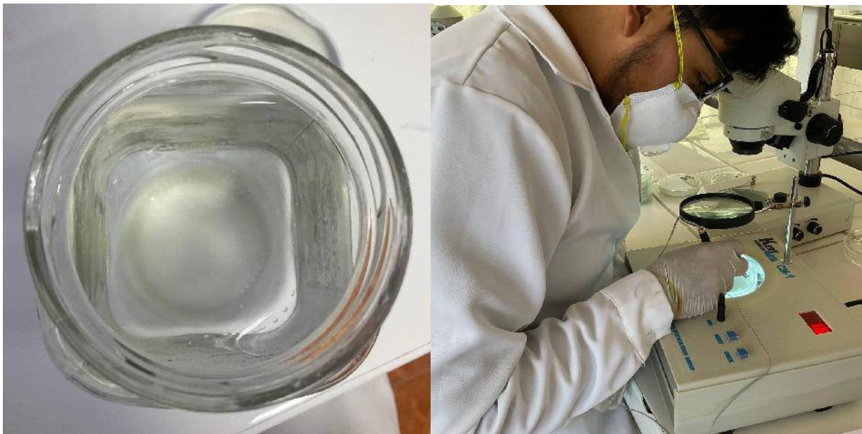
Figura 34: Muestra en blanco procesada simultáneamente con las muestras de la zona de ablación y observación preliminar de los MPs a través de un estereoscopio
