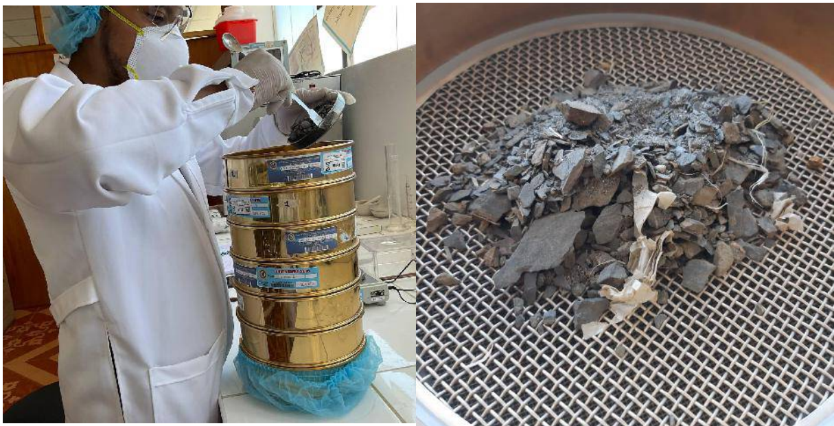
Figura 36: Separación por granulometría a través de tamices de sustrato zona de ablación
