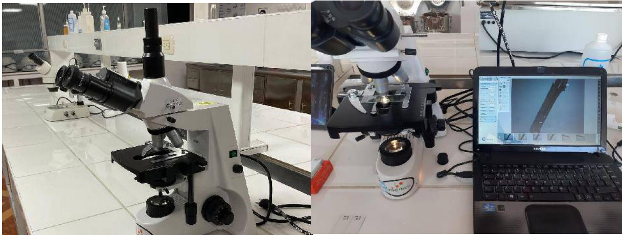
Figura 38: Observación y medición de los MPs hallados en cada una de las muestras extraídas de la zona de ablación de la Cordillera de Apolobamba, la Rinconada
