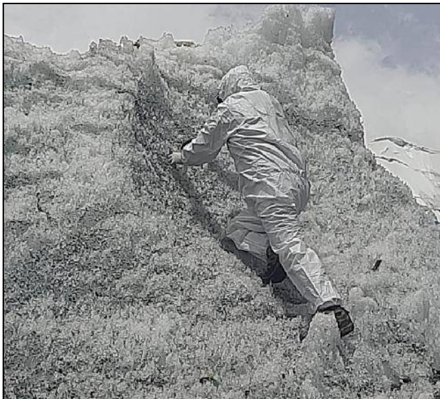
Figura 20: Fotografía de la extracción de muestras de nieve superficial zona de ablación
