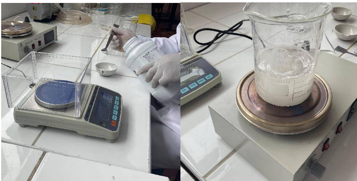
Figura 30: Preparación de solución de alta densidad con NaCl, para la separación de MP de las muestras de la zona de ablación
