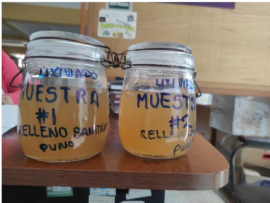
**Figura 53:** Muestras de aguas vertidas con lixiviados.
