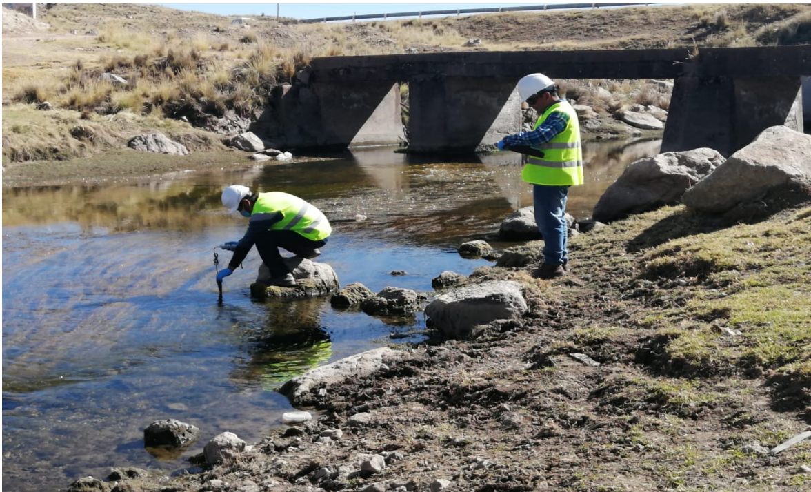
Figura N° 33: Medición de los parámetros fisicoquímicos en el punto RZ-1 en el río Zapatilla a 1500 metros de la carretera Panamericana.
