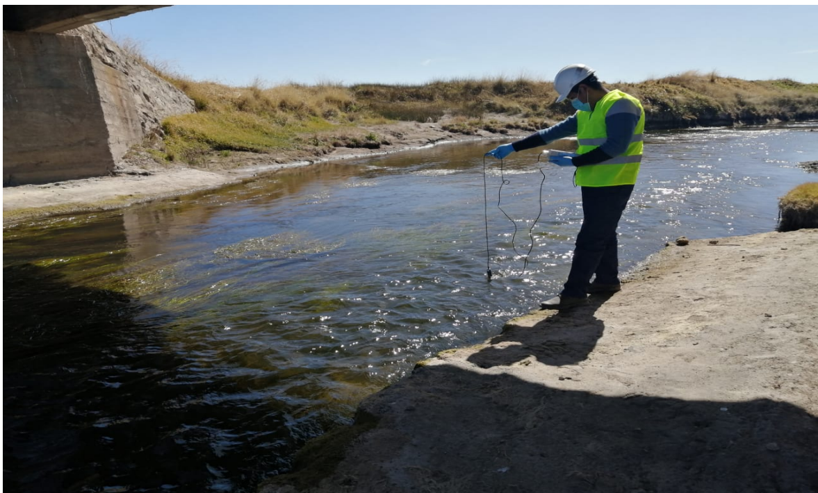
Figura N° 39: Medición de los parámetros fisicoquímicos en el punto RZ-3 en el río Zapatilla a 4500 metros de la carretera Panamericana.
