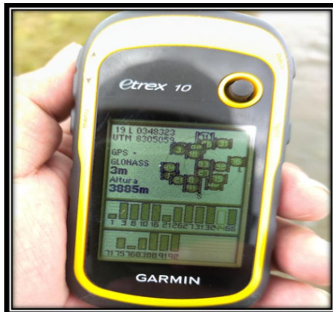
**Figura 14:** Ubicación de información de Geolocalización en Equipo de Posicionamiento GPS
