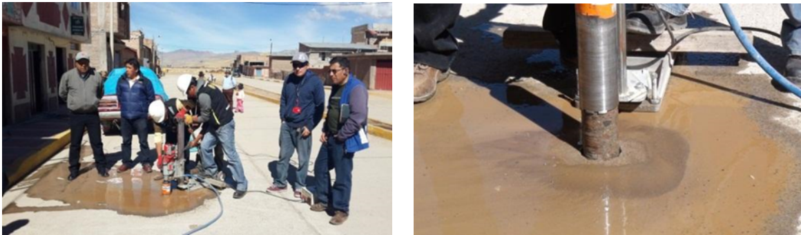
Figura 09: Toma de muestras mediante ensayo de diamantina.
