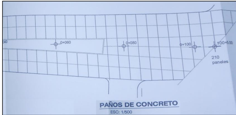
Figura 04: Detalle que muestra, la colocación de juntas entre los paños del pavimento
