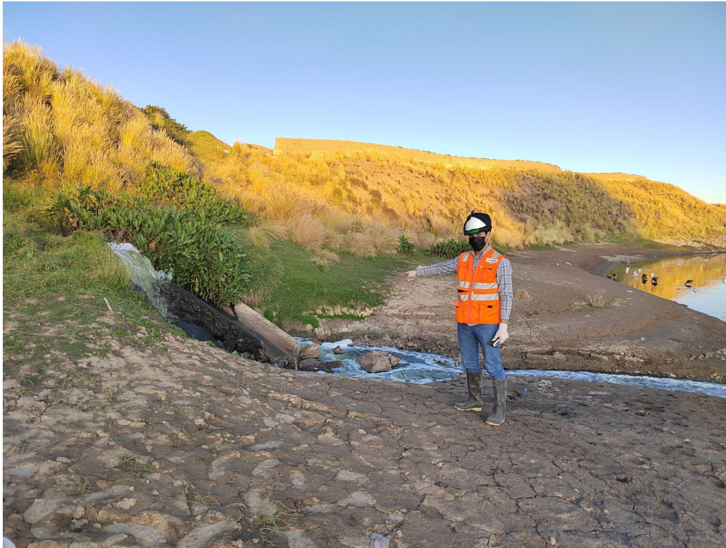
Figura 82. Identificación de punto de vertimiento de aguas residuales domésticas.
