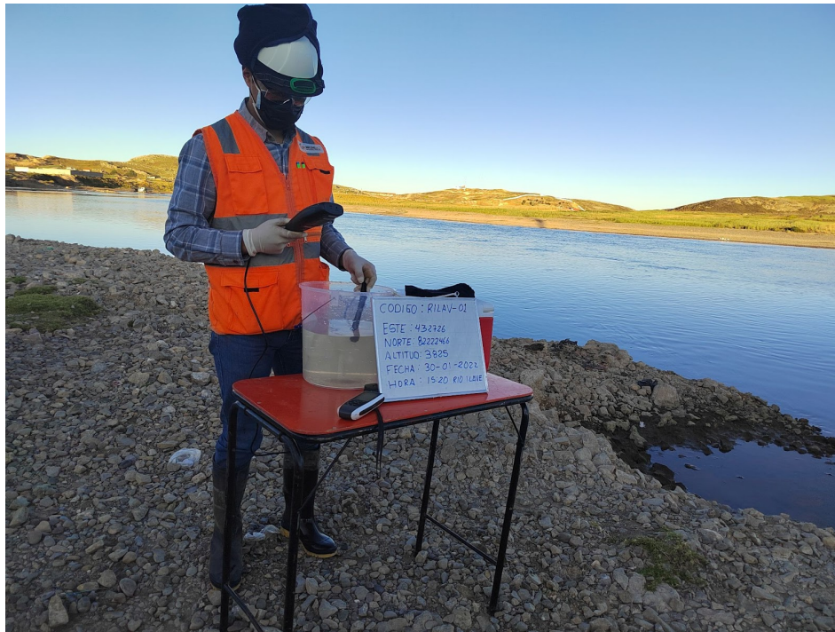
Figura 48. Medición de parámetros In Situ del primer muestreo (Punto 1).
